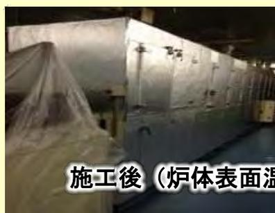
施工後 (炉体表面温度28°C~40°C)
